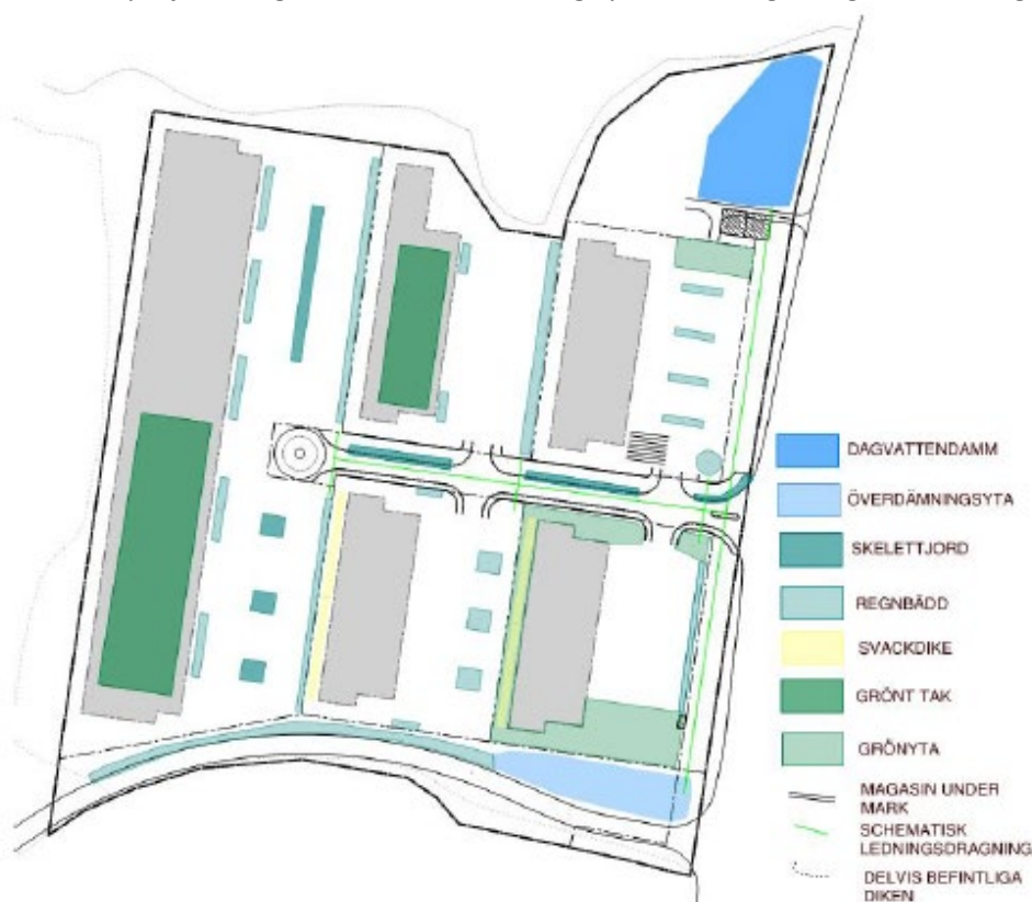
Figur 15. Exempel på systemlösning för dagvattenhantering med ungefärligt ytbehov för olika typer av dagvattenanläggningar. Illustreras för fyra av fem fastigheter. Projektering av kvartersmarken och dess dagvattensystem sker i detalj i ett senare skede. (Dagvattenutredning 3, 2023)
