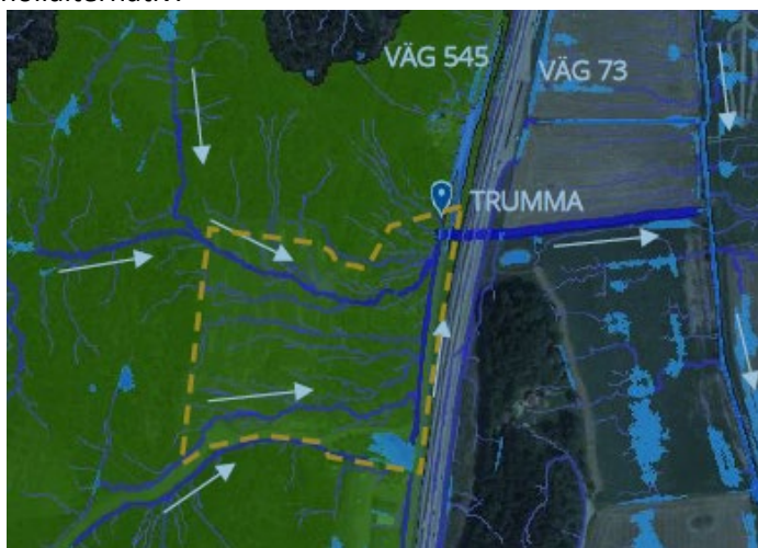
Figur 11. Avrinningsområde till trumman under väg 545 och väg 73, illustreras i grönt. Planområde gul streckad linje. Pilar visar avrinningsstråk. (Dagvattenutredning 3, 2023)
