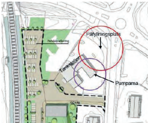
Skyddsavstånd från påfyllningsplatsen anges med röd ring, skyddsavstånd från bensinpumparna anges med lila ring. (Norconsult)
