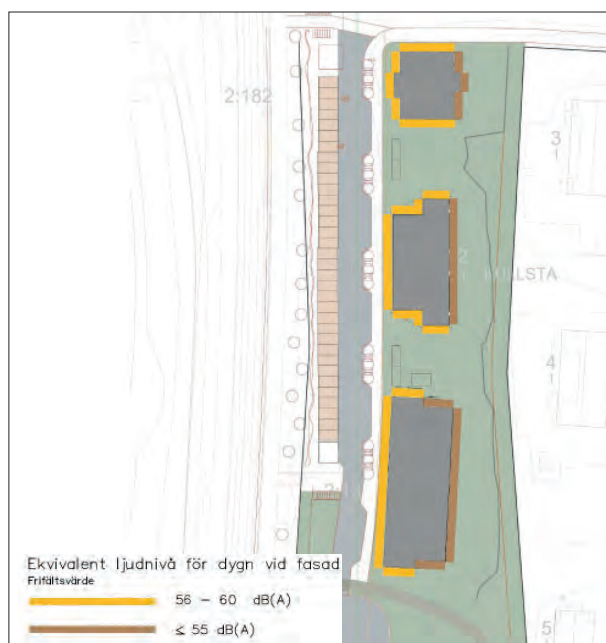
Exempel från bullerutredningen (AH Akustik) på minimimått på balkong som dämpar trafikbullret med upp till 5 dB(A) ekvivalent ljudnivå vid sida mot balkongen. Ljudabsorbent med lägst ljudabsorptionsklass B.
