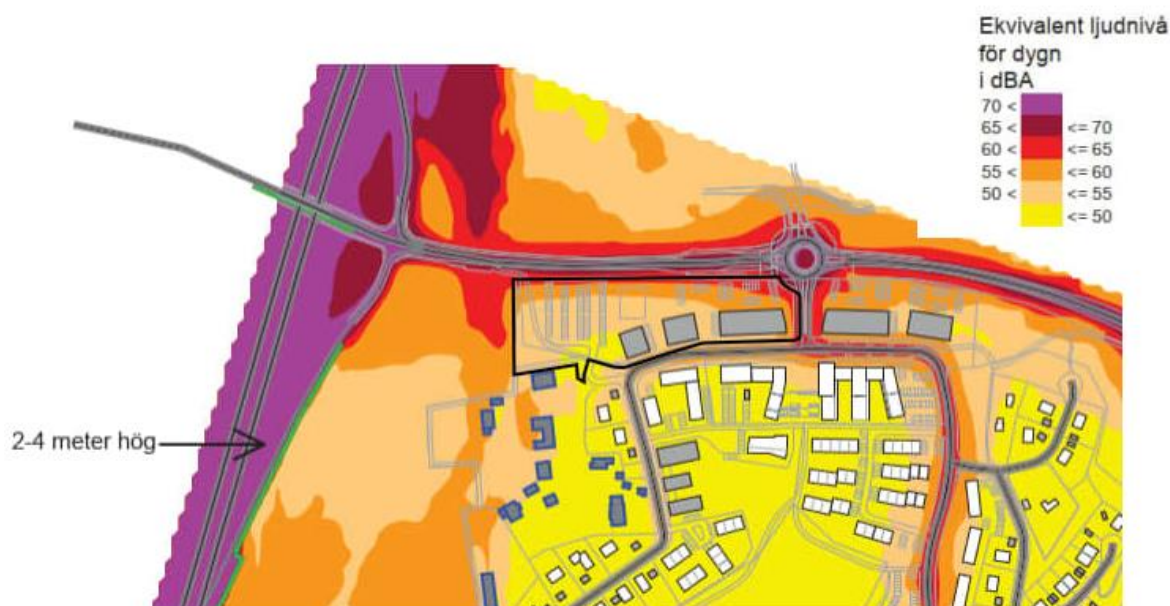
Illustration från bullerutredningen som visar ekvivalenta bullernivåer. Planområdet är ungefärligt markerat med svart avgränsning.
