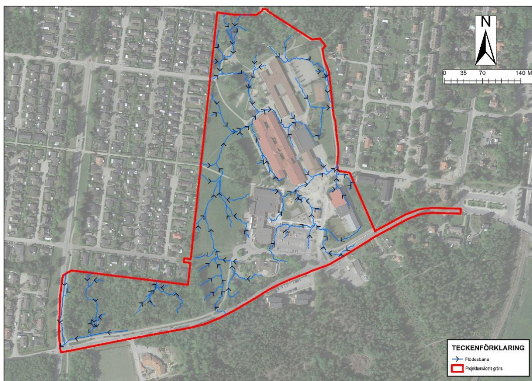
Figur 3-4 Avrinningsflödesnät från SCALGO-analys (blå linjer med beskriven rinnvåg) inom projektområdet i nuvarande situation.
