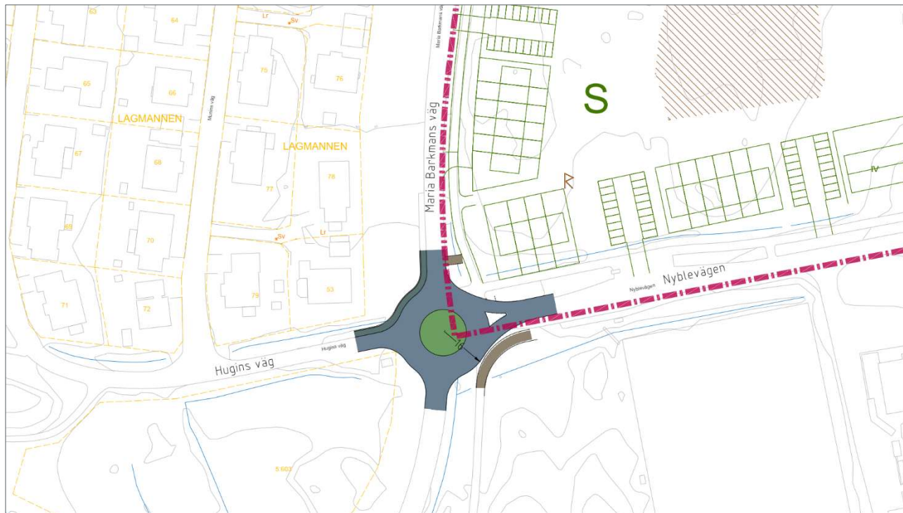
Figur 20. Alternativ för vändmöjlighet för buss genom cirkulationsplats i korsning med Maria Barkmans väg.
