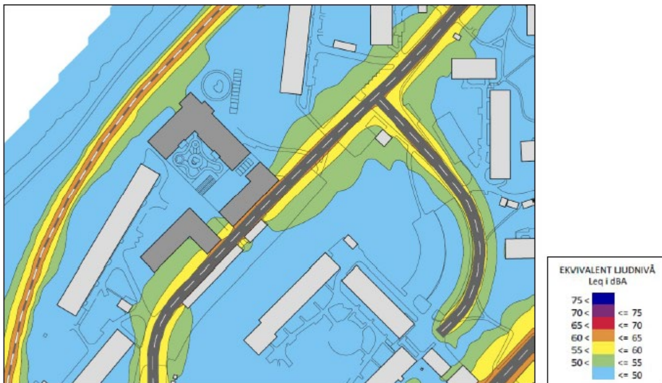
Figur 20: Bullerkarta, ljudutbredning på 1,5 m höjd. Ekvivalent ljudnivå. Prognos 2040 maximal exploatering.
