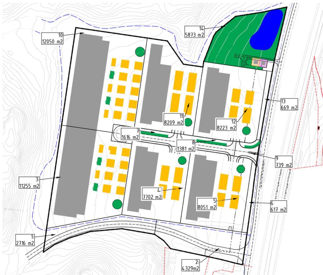
Figur 3-1 Markkartering för dimensionering av dagvattenledningar i planområde
