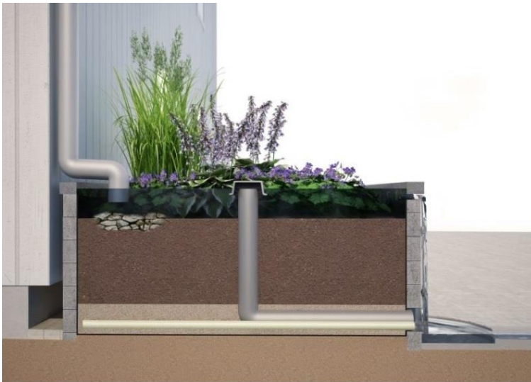
Figur 1 Principskiss av växtbädd för rening och fördröjning av takvatten (Bildkälla: Kristian Klasson & Kent Fridell Tengbomgruppen AB, 2014)
