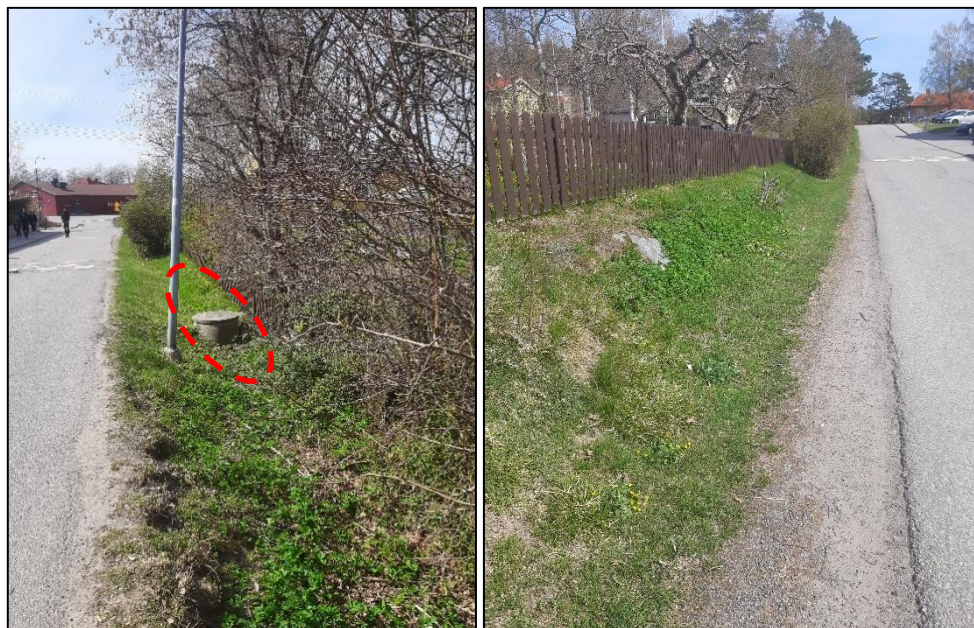
Figur 3:6. Befintliga grönytor intill Birkavägen. Till vänster ses befintlig nedstigningsbrunn till dagvattenledning tillsammans med röstreckad ellips som markerar ett område där vatten vid skyfall troligtvis rinner vidare mot befintligt villaområde. Fotografi från platsbesök 2022-05-04.
