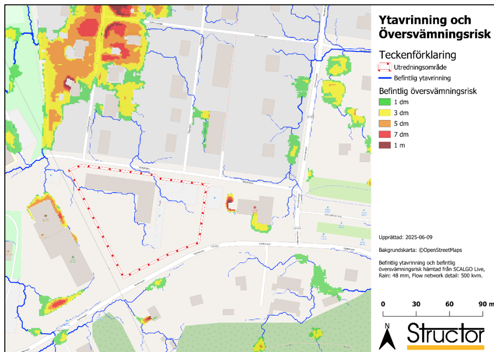
Figur 3:5. Befintlig ytavrinning och översvämningsrisk vid ett 100-årsregn med 1 timmes varaktighet, vid befintlig situation.
