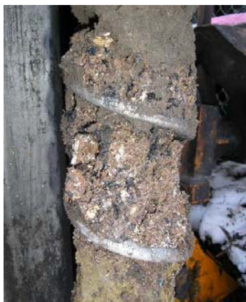
Foto 3. Avvikande skikt av fyllnadsmaterial i pp. 4.
